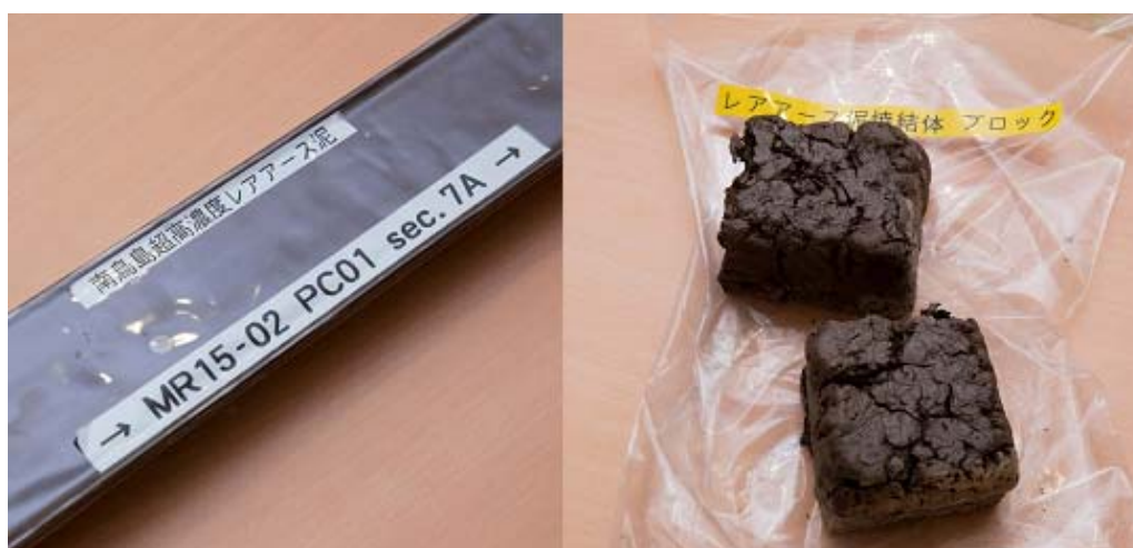
写真●会場で展示された南鳥島 EEZ 超高濃度レアアース泥（左）とリサイクル資材として、実際にレアアース泥残渣をブロック状に成型し電気炉で焼成した骨材
