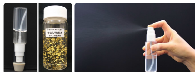
(左) CNF分散液の増粘性と金箔沈降防止効果(資料提供: 第一工業製薬株式会社) (右) スプレー可能で垂れないゲル(資料提供: 第一工業製薬株式会社)
