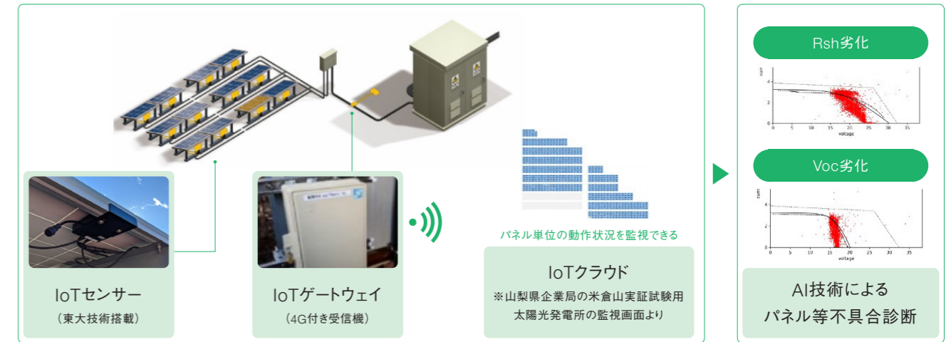
PPLC IoTに基づく精密検査技術(資料提供:ヒラソル・エナジー社)
