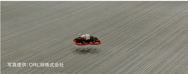
ブレドープSiを利用した軽量高エネルギー電池によるドローン飛行実験の様子
