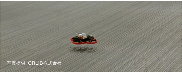
ブレドープSiを利用した軽量高エネルギー電池によるドローン飛行実験の様子
